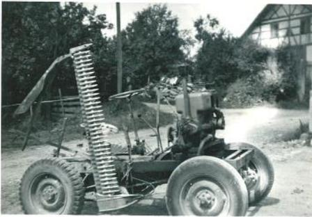
Während des zweiten Weltkrieges kaufte Moßgöller das Sägegatter der Familie Flory, um Schlittenkufen aus einem Stück Holz schneiden zu können. Ferner baute der findige Handwerker auch Traktoren mit Messerbalken und einem 12 PS Farimann Motor.
